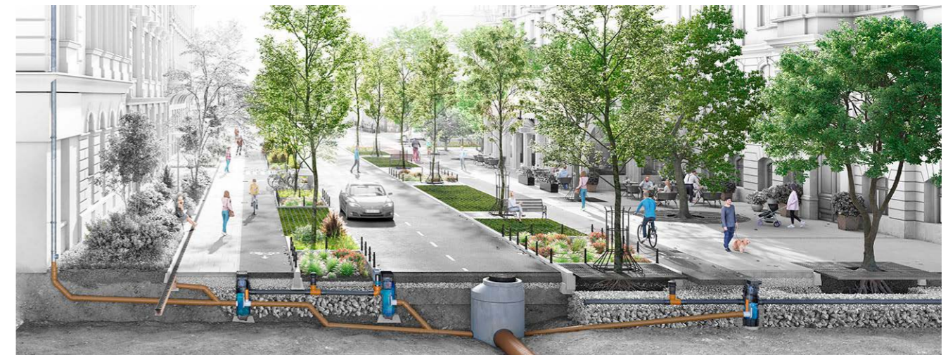
© ACO Wasserabfluss in der Schwammstadt
